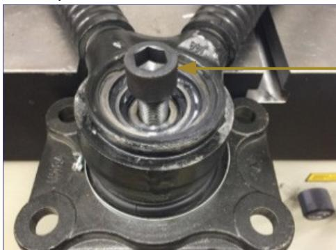
Ajustar el perno para separar la placa del buje de ápice
