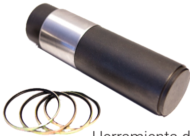
Herramienta de impulsión de juntas y bujes de bronce
